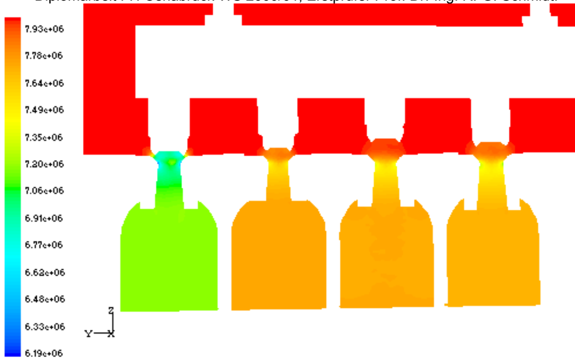
Bild: Statischer Druck in den Ventilen einer Düsendruppenregelung
